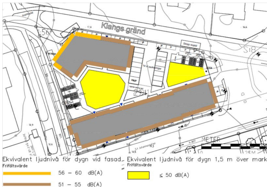
Bild 36. Utdrag ur trafikbullerutredningen, som visar den beräknade ekvivalenta ljudnivån vid fasad och 1,5 meter över mark för år 2030. Observera att illustrationen är schematisk och att läget för byggrätterna justerats något sedan granskningen. Illustration: Åkerlöf Hallin Akustikkonsult AB
