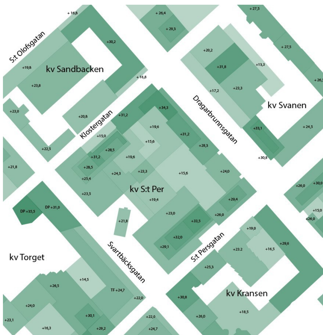
Befintliga höjder på bebyggelsen i kvarteret S:t Per och befintliga höjder utanför planområdet.
