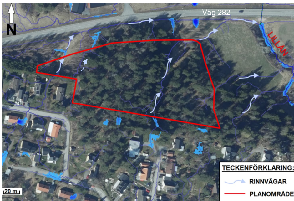
Figur 10. Flödesvägar (blå färg) inom och i anslutning till planområdet (i rött). Flödesriktning presenteras med ljusblå pilar (ScalگوLive, 2023).
