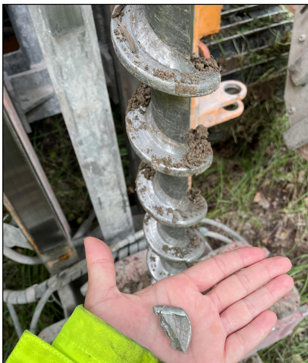
Figur 6. Del av skruvtopp som gick av i punkt 23S03.
