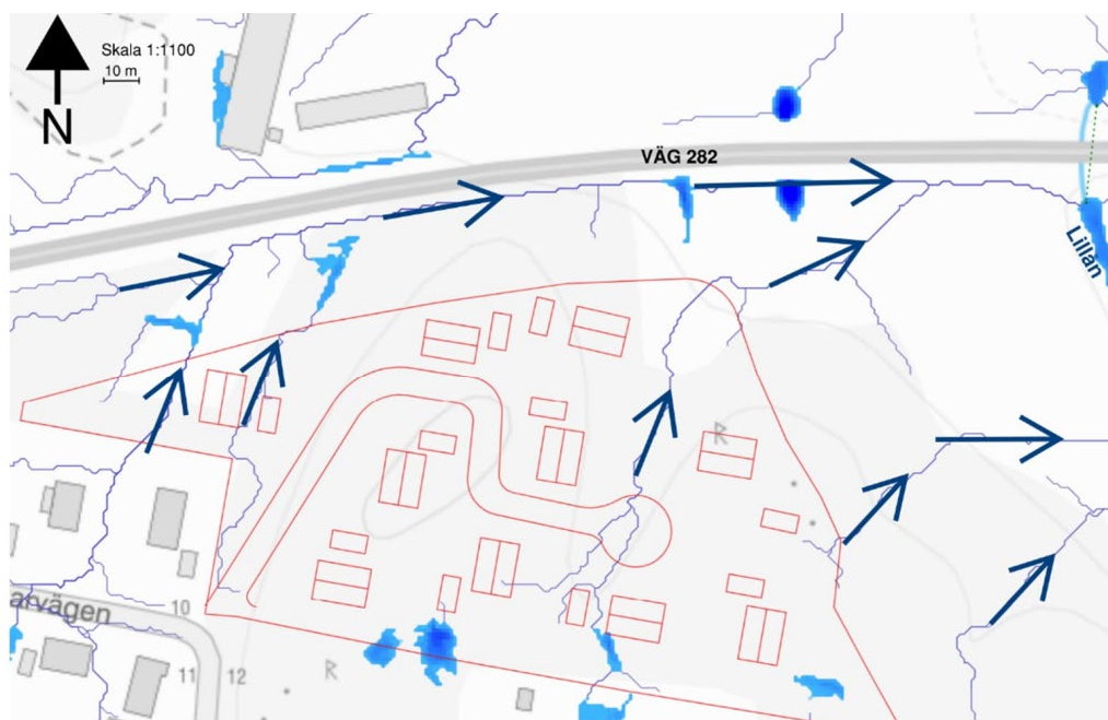
Figur 26. Ytliga rinnvägar och instängda områden i lokala lågpunkter vid skyfall (68 mm, motsvarande 100-årsregn med 60 minuters varaktighet, klimatfaktor 25%). Rinnvägar presenteras med blå pilar. Sweco
