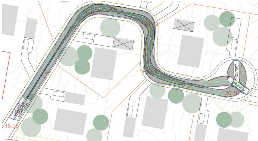
Figur 18. Körspår med typfordon LBn lastbil på 12 meter. För LBn krävs vändning med backning. Bild. Sweco
