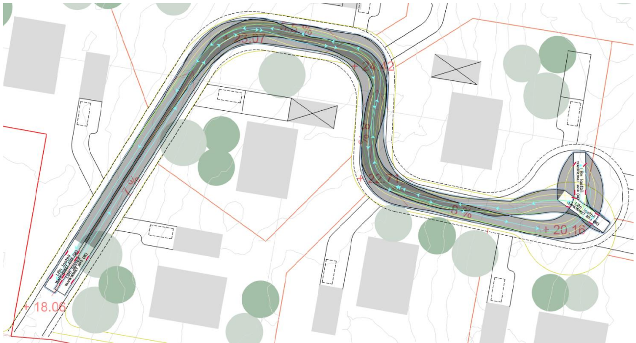
Figur 11. Körspår med typfordon LbN lastbil på 12 meter. För LbN krävs vändning med backning.
