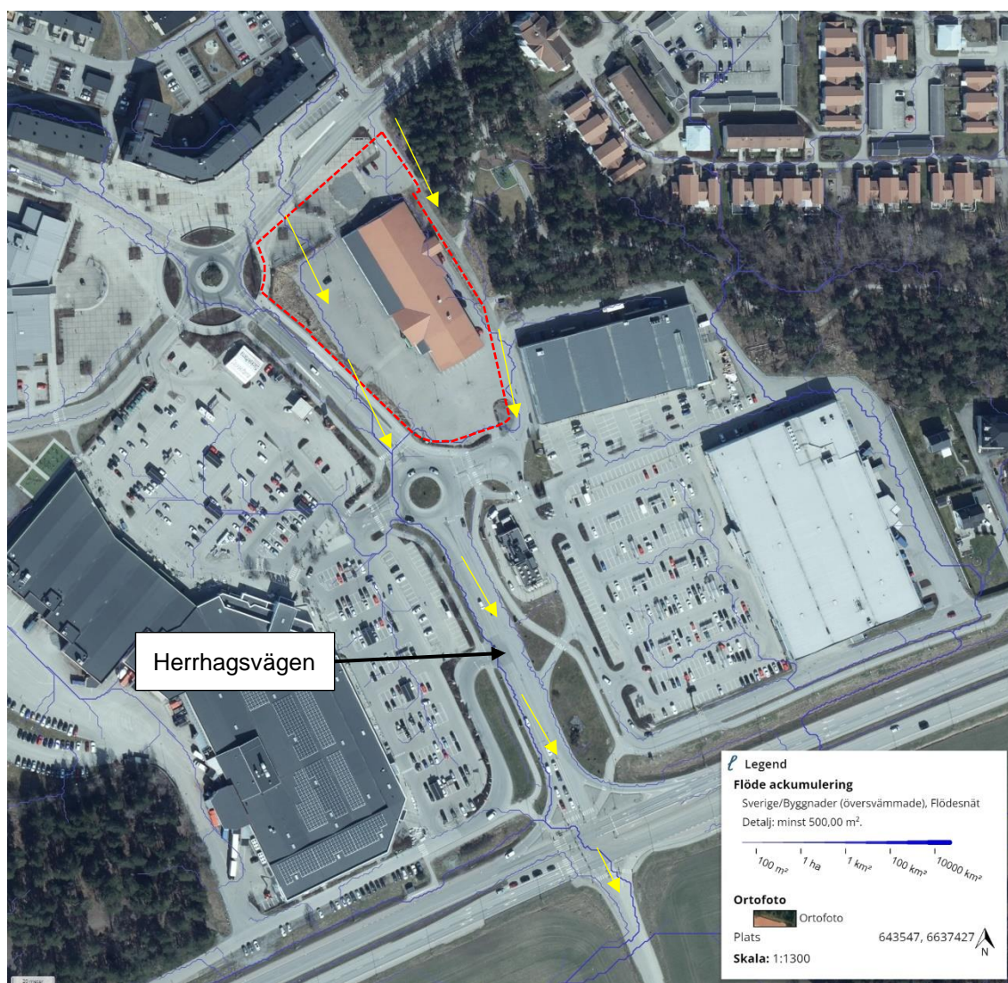
Figur 9. Ytliga avrinningsområden och avrinningsvägar inom och omkring utredningsområdet, från SCALGO Live. © Lantmäteriet. Utredningsområdet inom röstreckad linje. Rinnvägar visas med tunna blåa linjer och generell rinnriktning med gula pilar.
