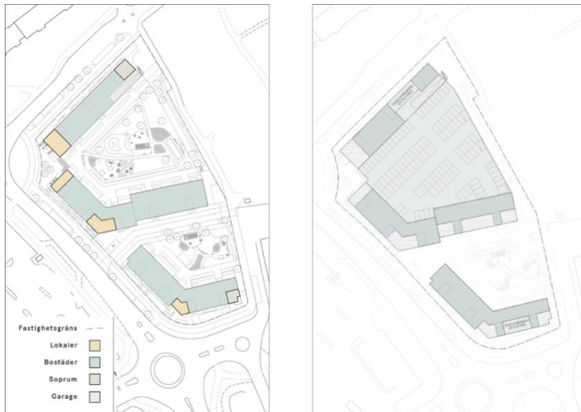
Figur 12. Till vänster: Föreslagna placeringar för lokaler och soprum. Till höger: Föreslagen placering av parkeringsgarage. Underlag hämtat från Arkitekterna Krook & Tjäder AB.
