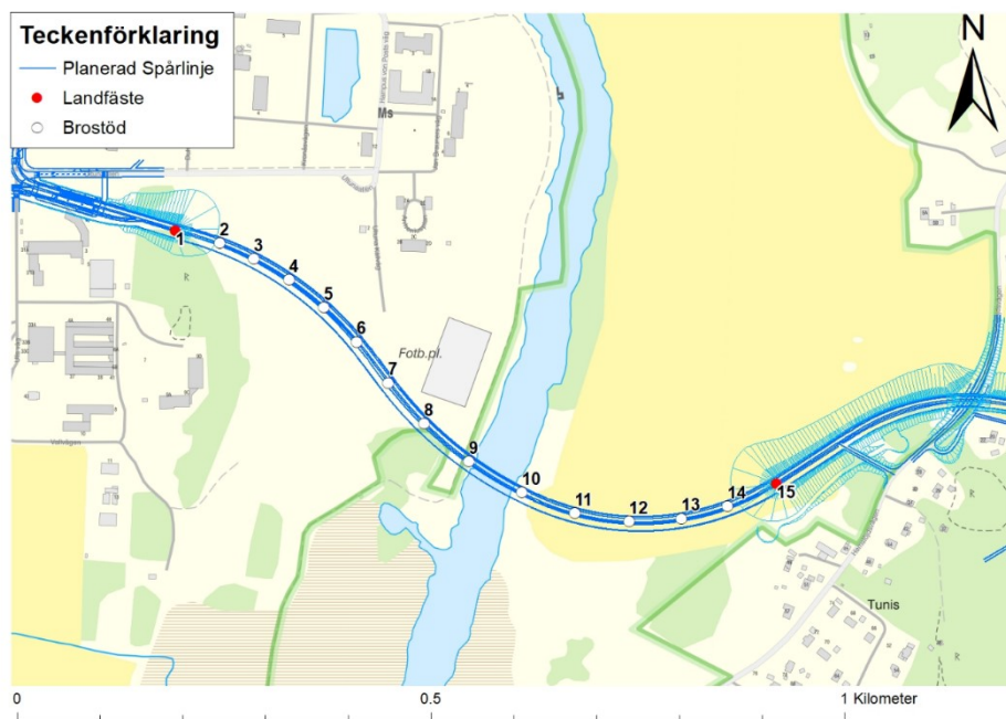
Figur 3: Planerad brosträckning med brostödens placering.
