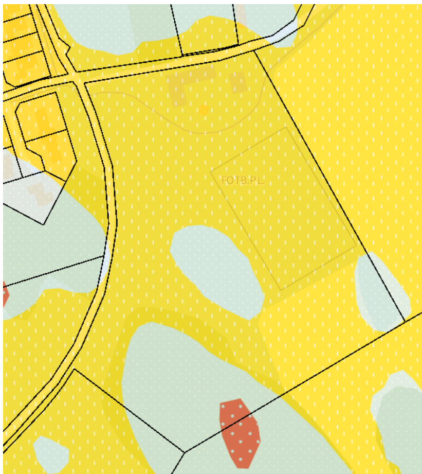
Figur 23: Utdrag från jordartskartan. Planområdet består i huvudsak av glacial silt (gul), sandig morän (grå) samt urberg och morän (röd).
