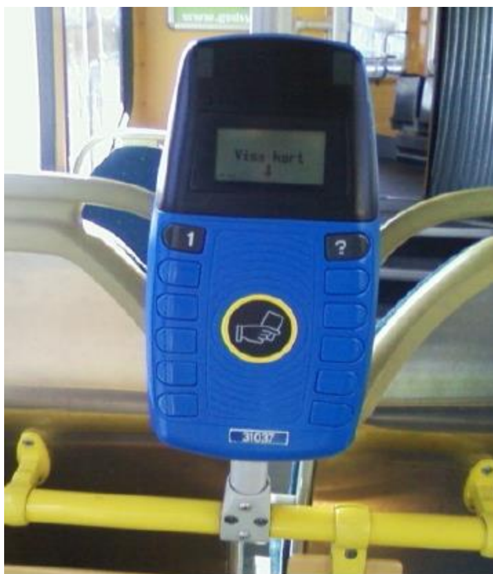
Figur 7.1 Läsare för RFID-biljetter som används av Västtrafik arbetar vid frekvensen 13,56 MHz.
