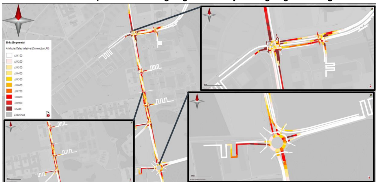
Figur 34. Relativ fördröjning Dag Hammarskjölds väg med cirkulationsplats vid korsning Dag Hammarskjölds väg/Regementsvägen.
