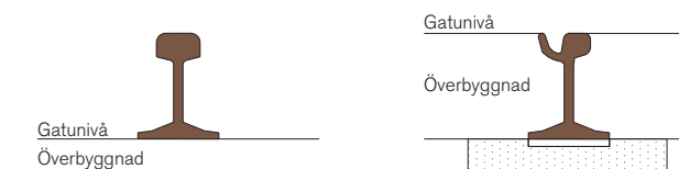
Figur 27. Principsektion för vignolräl och gaturäl.
