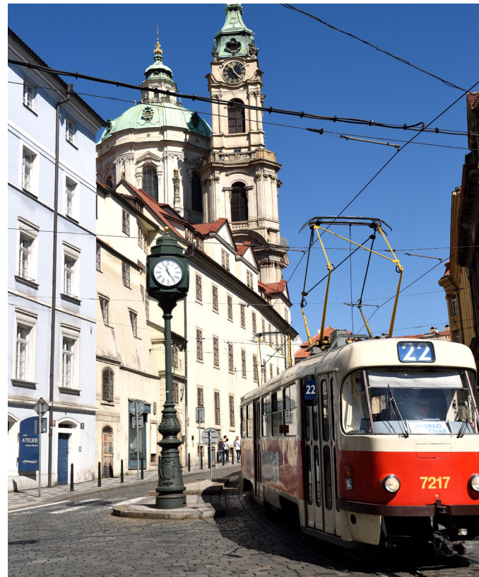
Figur 92. Fasadspänd kontaktlednings, Foto: Tim Adam, Prag
