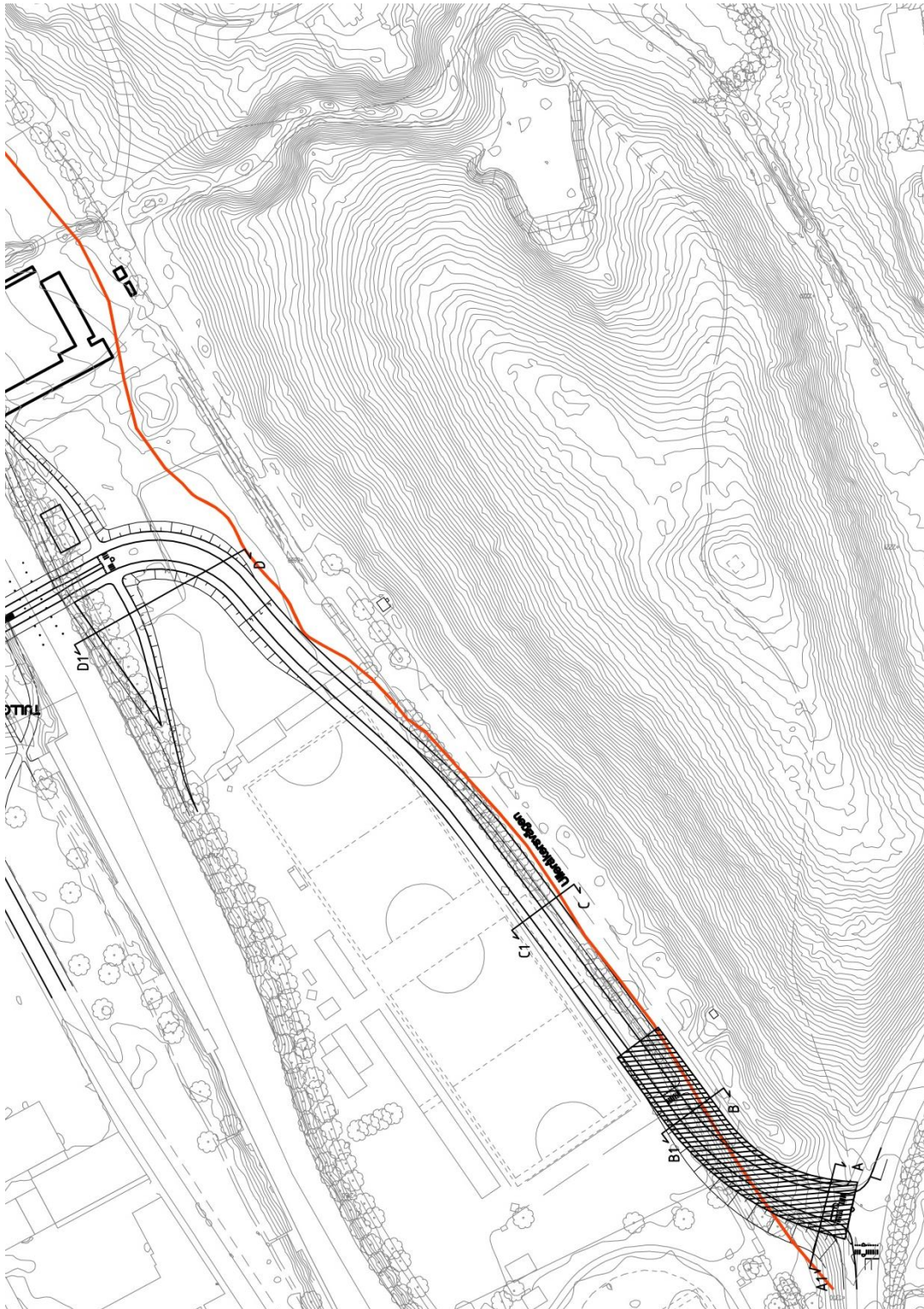
Plan Grundvattenskydd Grävskydd och bentonitlera inom skrafferat område. Röd linje illustrerar gräns för naturligt 10m tjockt lerlager. Söder om linjen, mot åsen, understiger lagertjockleken 10m.
