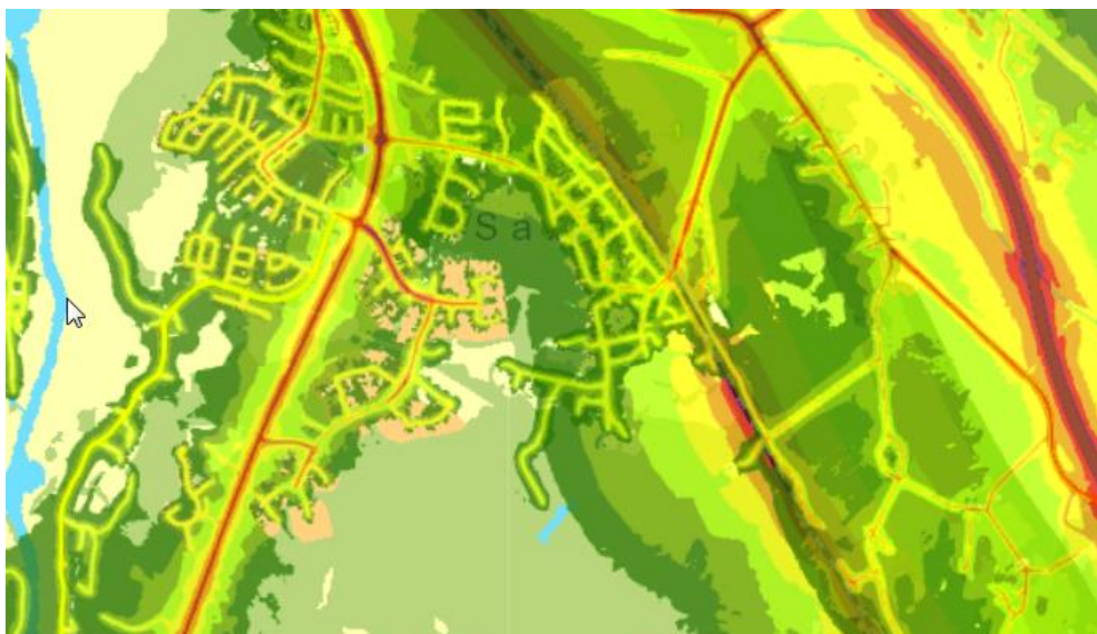
Figur 36. Bullerkartering. Ljusgrön färg i Lunsen visar på bullernivåer under 40 dBA. Övriga gröna färger är områden med 40–55 dBA. Gula och röda färger anger bullernivåer över 55 dBA. Källa: Uppsala kommun.
