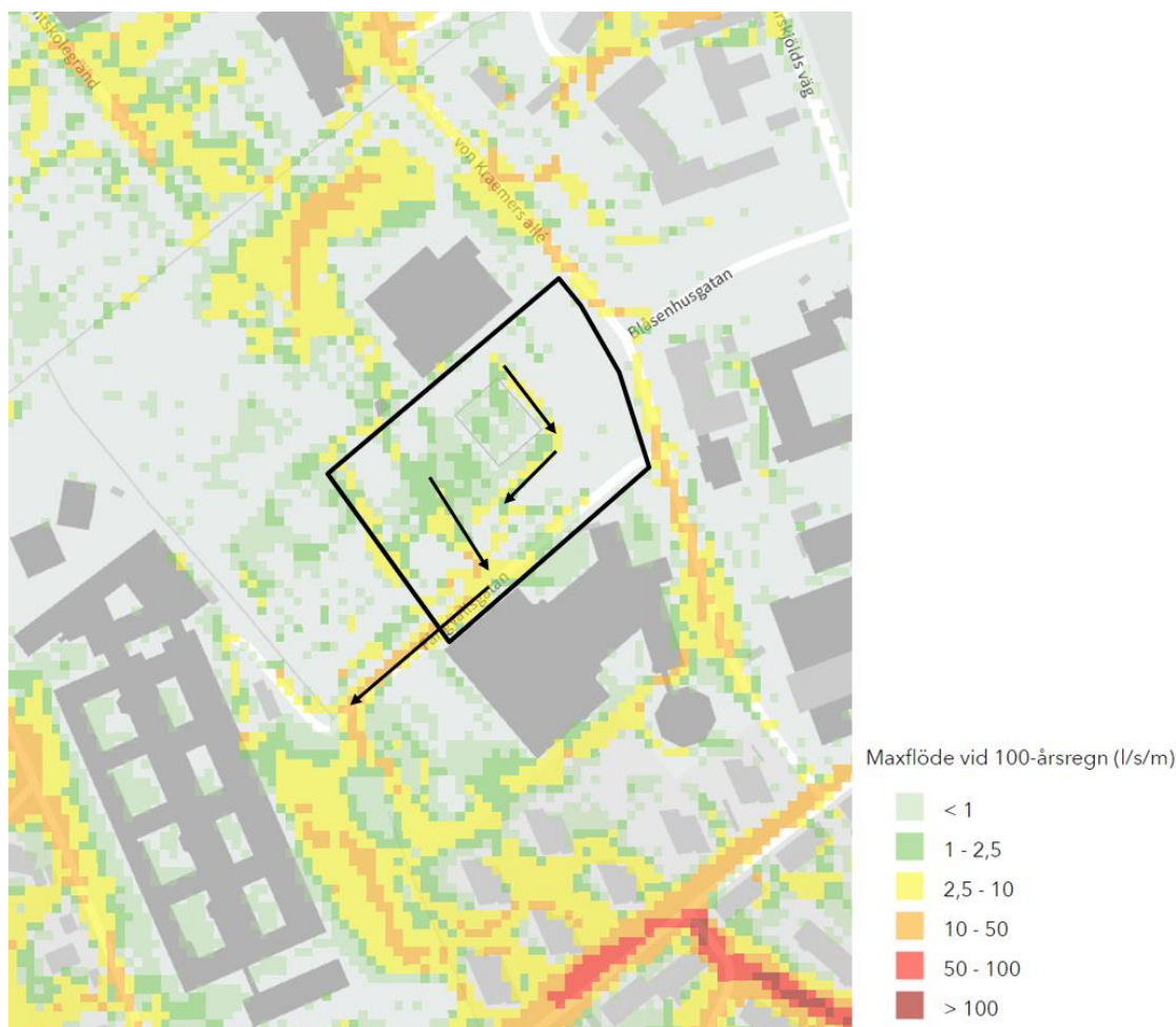
Figur 14. Utdrag från Uppsala vattens skyfallskartering. Utbredning av rinnstråk samt beräknat maximalt vattenflöde (liter per sekund per meter) vid ett framtida 100-årsregn. Flödesriktningar markerat med svarta pilar. Utredningsområdet markerat med svart linje. Bildkälla: Uppsala vattens skyfallskartering.
