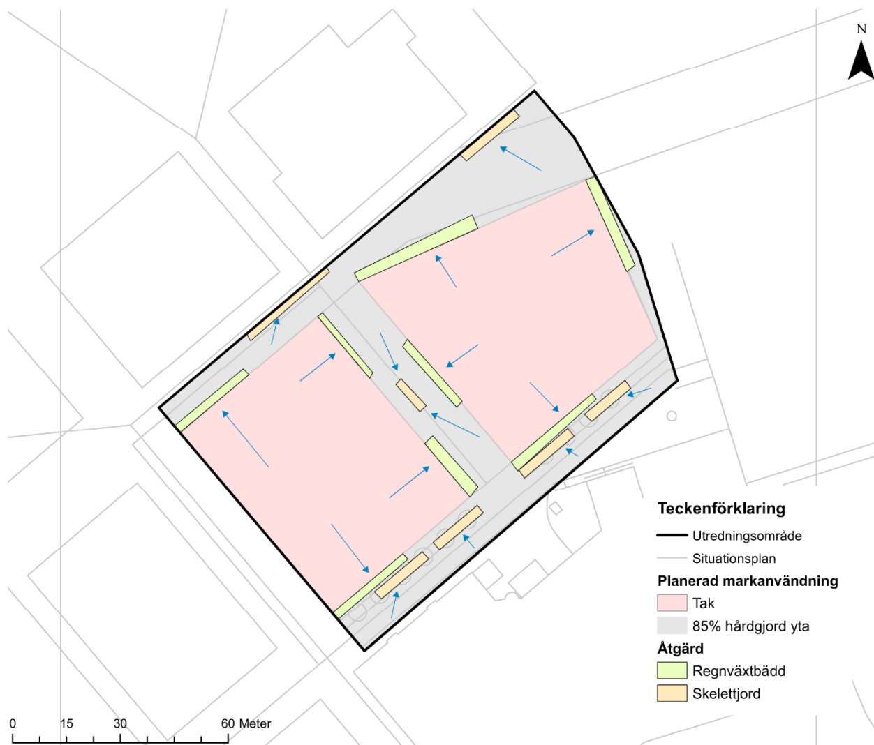
Figur 16. Åtgärdsförslag för planerad situation.
