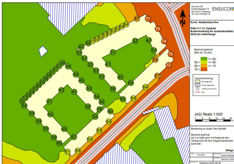
Figur 22. Beräkning av maximal ljudnivå 2030 års trafikmängd. Grön färg visar maximal ljudnivå under 60 dBA och ljusgrön mellan 60 och 65 dBA. Orange visar mellan 65 och 70 dBA och röd över 70 dBA. (Bild: Ensucon AB)
