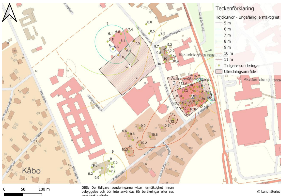
Figur 3. Interpolerad lermäktighet utifrån tidigare sonderingar. Nivåerna är från innan bebyggelsen inom respektive områden och ska ses som mycket ungefärliga. Underlagen för interpoleringen visas med gröna cirklar. Figuren är även lagd som bilaga i större format.
