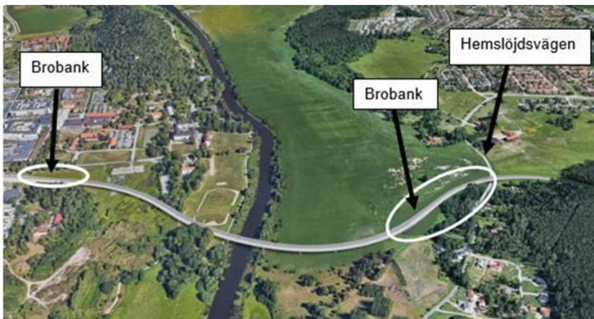
Figur 15. Visar brons sträckning genom landskapet. Bron går först över en stor gräsplan, vidare över vegetationen runt Fyrisån, över den öppna vattenspegeln, över odlingslandskapet öster om bron och landar i bankar. Hemslöjdsvägen korsas med en bro. Bild av Rundquist arkitekter.
