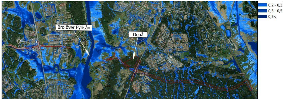
Figur 62. Översvämningssituation i och omkring planområdet med befintlig markanvändning. Källa: (Norconsult, 2023a).
