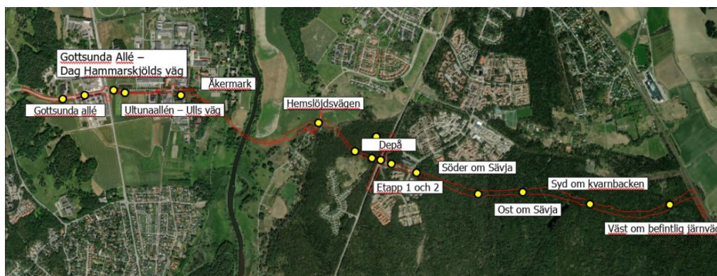
Figur 86: Ortofoto med elva områden markerade där vatten riskerar att samlas vid ett skyfall. Bild: Norconsult.
