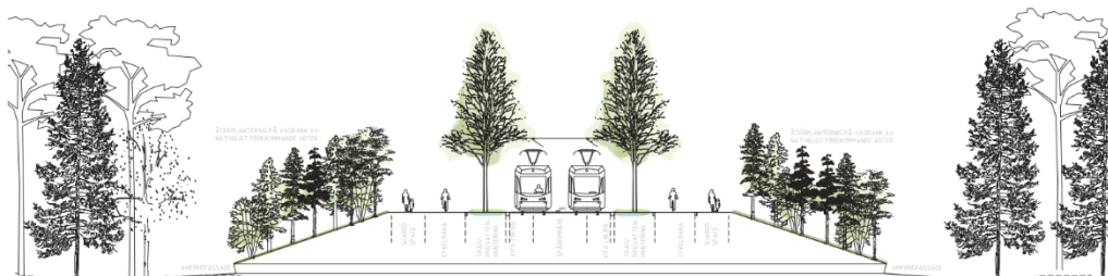
Figur 38: Sektion som visar möjlig utformning av marknära brokonstruktion, även kallat landskapsbro. Gatan går på en bank med ett underliggande tunnelsystem för groddjur. Broarna kommer också att vara framkomliga för motorfordon. Bild: White arkitekter.
