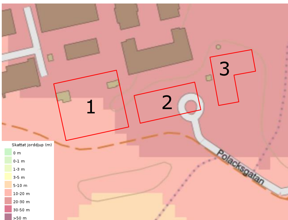
Figur 3. Jorddjupskarta hämtad 2023-09-25 ©Sveriges Geologiska Undersökning (SGU:s bedömda jorddjup). Undersökt område är inom de röda markeringarna.
