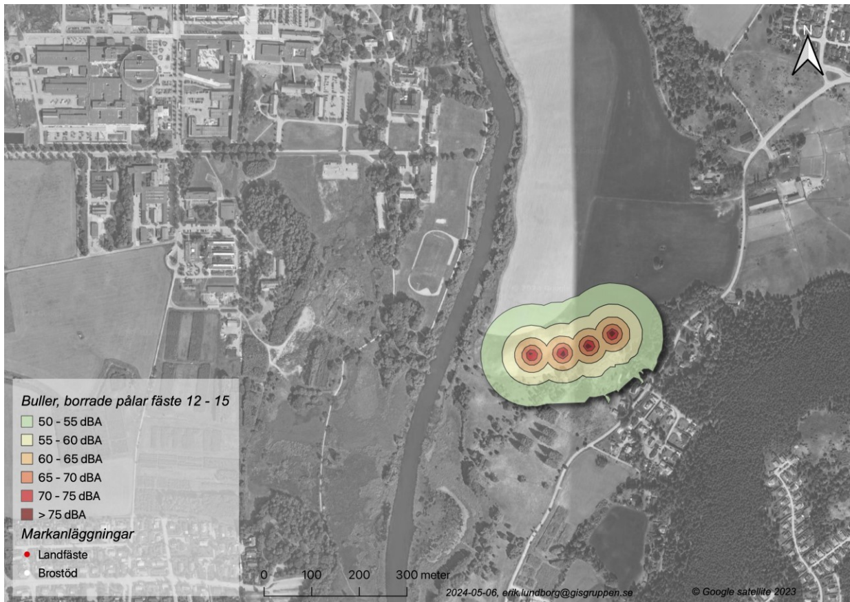
Figur 4b. Beräkning av bullernivån från borrade pålar för brostöd nr 12-15 på östra sidan av Fyrisån. Gränsen för påverkan på värdefulla fågelområden (50 dBA) startar vid varje brostöd och ut till och med den gröna ytterskivan och inåt.
