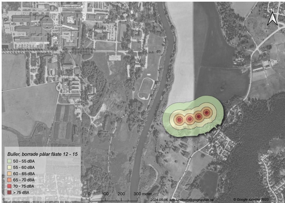
Figur 32. Förtydligande av Figur 31, bullerutbredning för borrade pålar vid brostöd 12–15.
