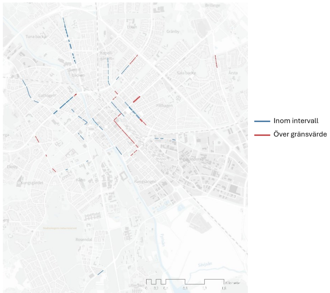
Figur 73. Rödmarkerade sträckor riskerar att överskrida gränsvärdena för PM10 år 2050. Blåmarkerade sträckor är under gränsvärdet. Trafikprognos trend för 2050.
