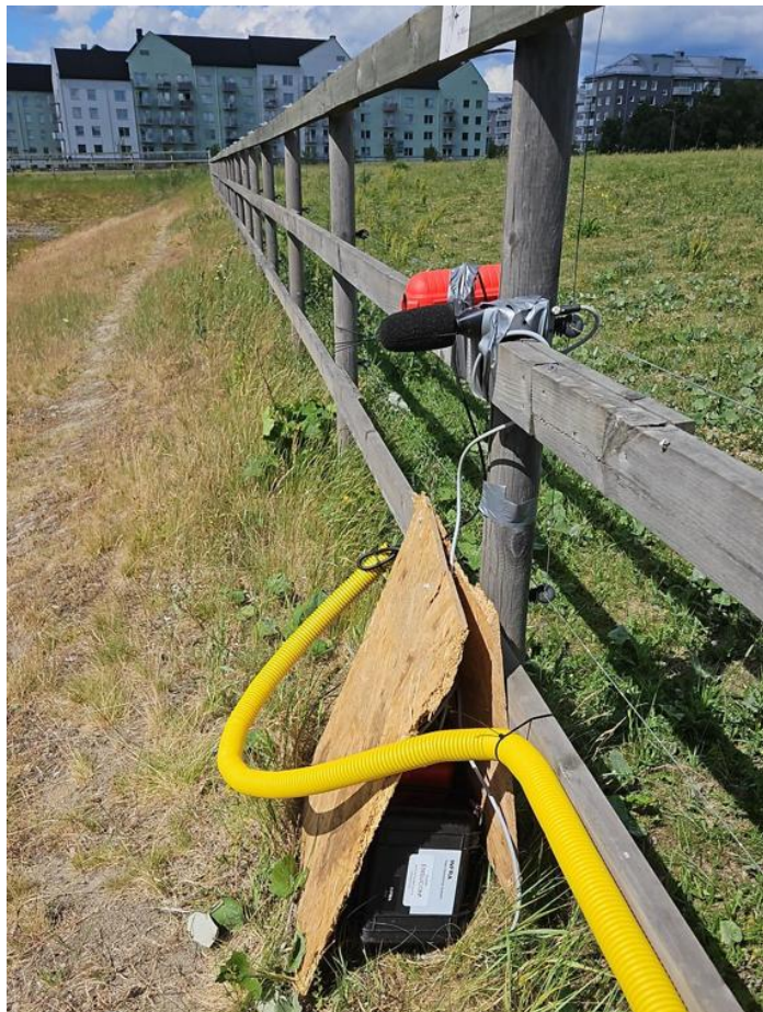
Figur 4 Mikrofonmontering vid hagen, Mp3.
