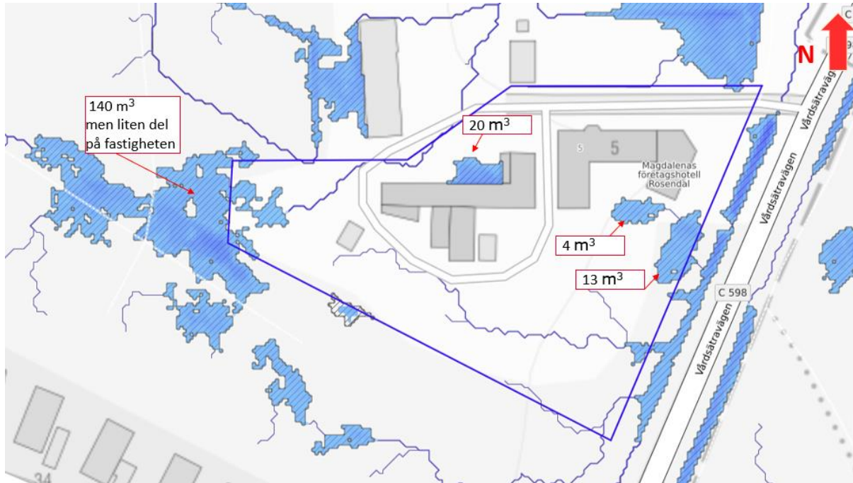
Figur 13. Lågpunktskartering i Scalgo Live. Blå indikerar lågpunkter som kan fyllas med vatten. Mörkblå smala linjer är rinnvägar i befintlig terräng.
