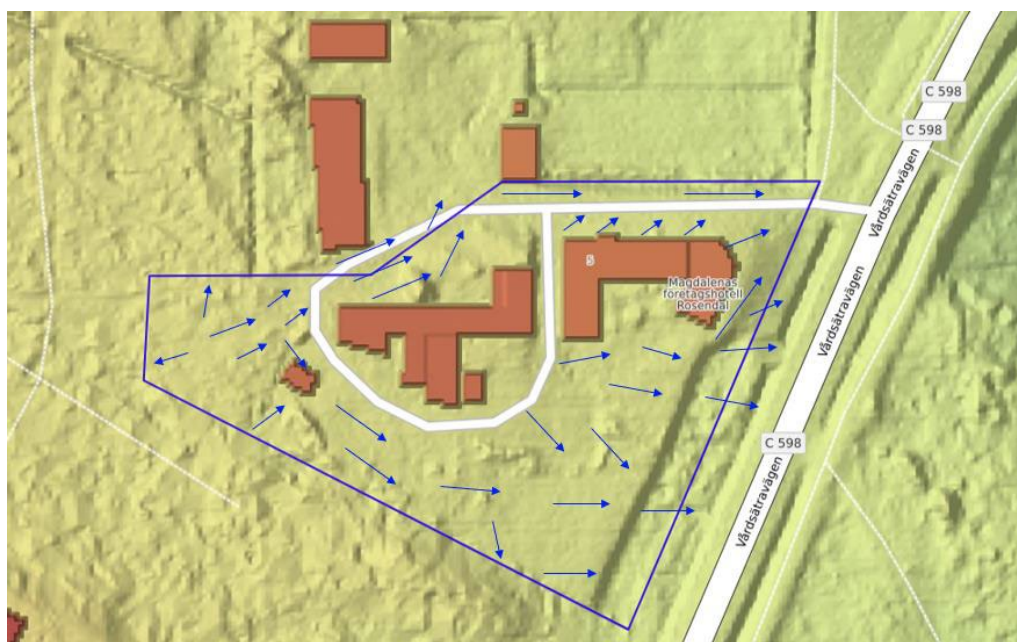
Figur 24 Bilden visar befintlig avrinning. Blå pilar visar befintliga rinnvägar för ytvatten. Källa: Ramböll AB.
