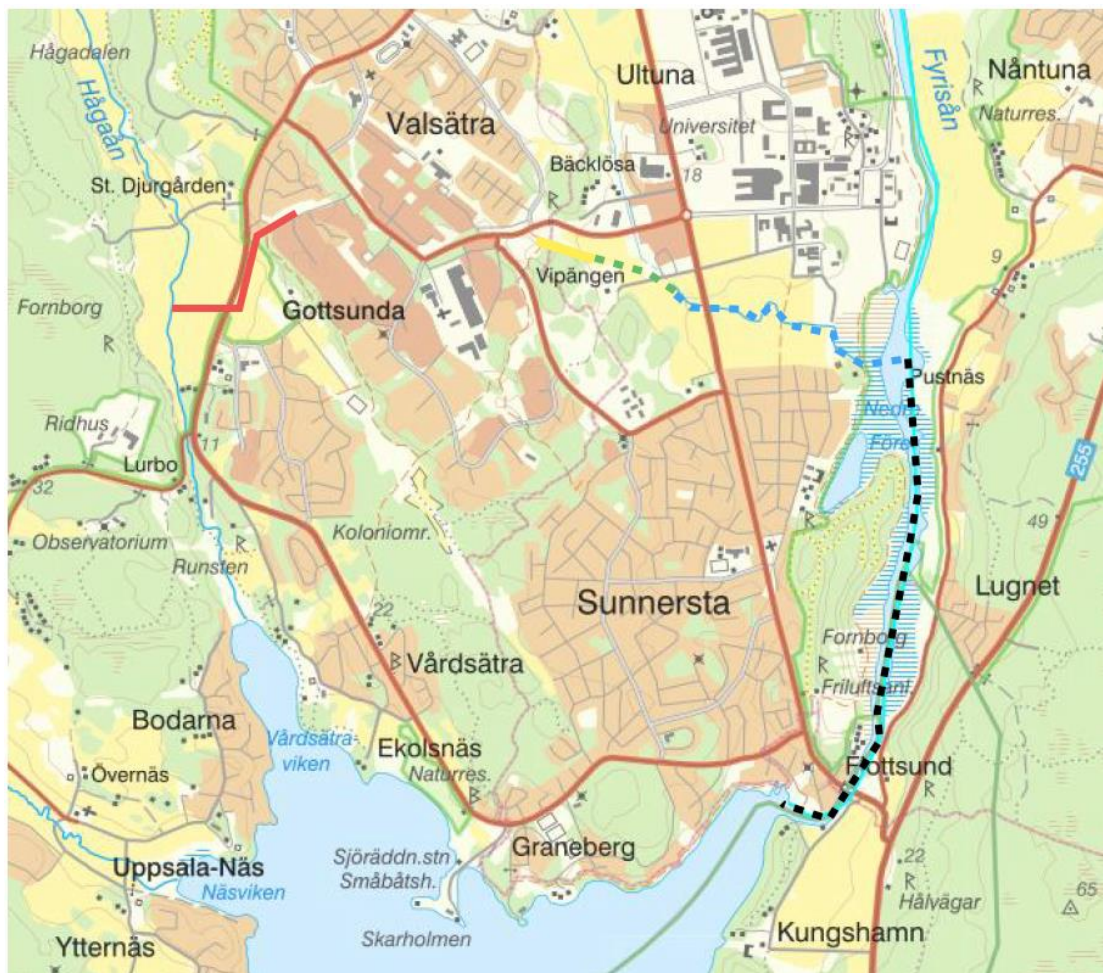
Figur 10. Utlopp från utredningsområdet till Hågaån (röd linje), utlopp till Ravinen (gul linje) som via kulvert (streckad grön linje) mynnar ut i Bäcklösadiket (streckad blå linje) som slutligen avvattnas i Fyrisån Ekoln-Sävjaån (streckad svart linje).
