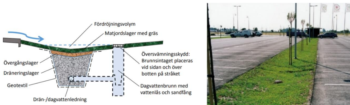
Figur 30. Principskiss av ett infiltrationsstråk (WRS) till vänster. Stråket utformas som ett nedsänkt dike där vattnet kan infiltrera genom matjorden till ett dräneringslager. Ett dräneringsrör som ansluter till dagvattennätet kan placeras i botten. (Stockholm Vatten och Avfall, 2017d).
