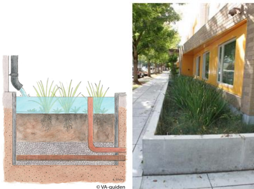
Figur 22. Till vänster: Principskiss över en regnbädd (VA-guiden). Till höger: Exempel på en regnbädd på kvartersmark (Stockholm Vatten och Avfall)
