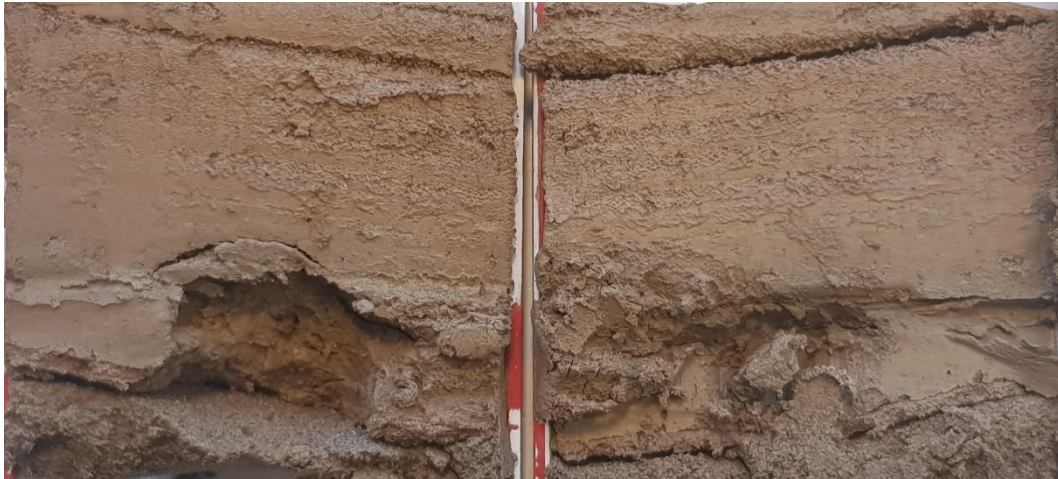
Figur 1 Borrpunkten, 22W006, 4,0 m, Jordprovet i nedre delen av mellanhylsan delad longitudinellt provhylsan med id Bjerking 1549.
