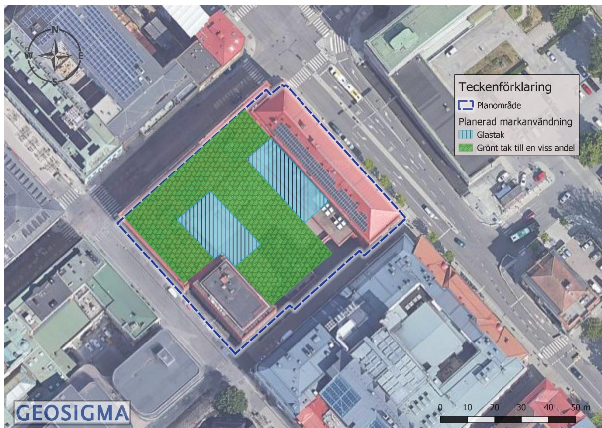
Figur 6-3. Förslag till ungefärlig dimensionering av dagvattenlösningar i form av grönt tak som anläggs på 90 % av den nya takytan.
