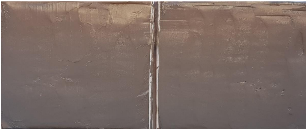
Figur 2 Borrpunkten, BG20006, 4,5 m, Jordprovet i nedre delen av mellanhylsan delad longitudinellt provhylsan med id Bjerking 1421.
