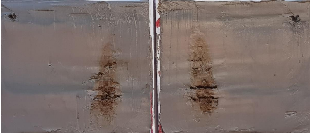
Figur 1 Borrpunkten, BG20006, 3,0 m, Jordprovet i nedre delen av mellanhylsan delad longitudinellt provhylsan med id Bjerking 1333.
