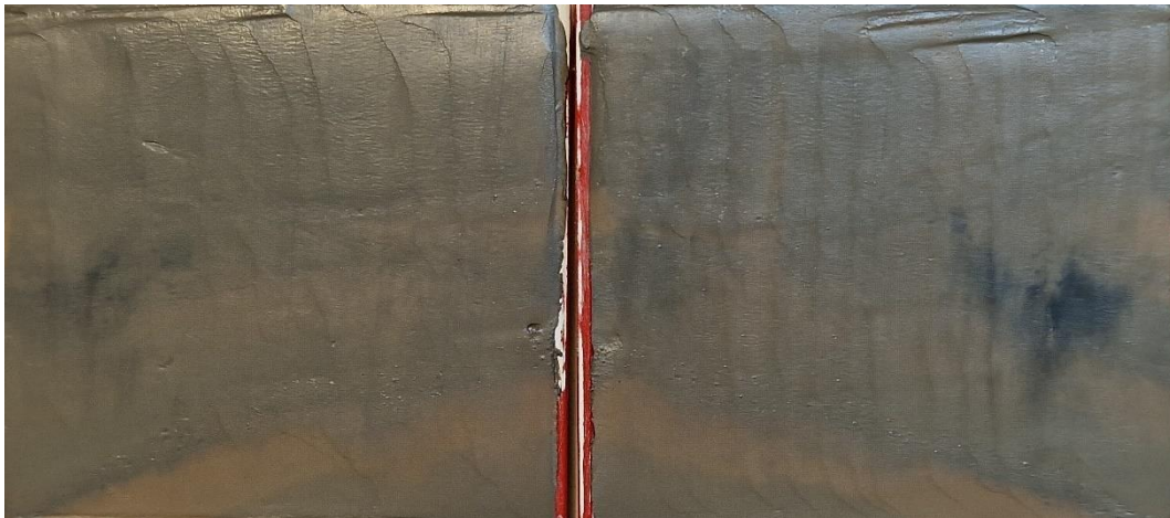
Figur 7 Borrpunkten, 23B20, 5,0 m, Jordprovet i nedre delen av mellanhylsan delad longitudinellt provhylsan med id Bjerking 1242.
