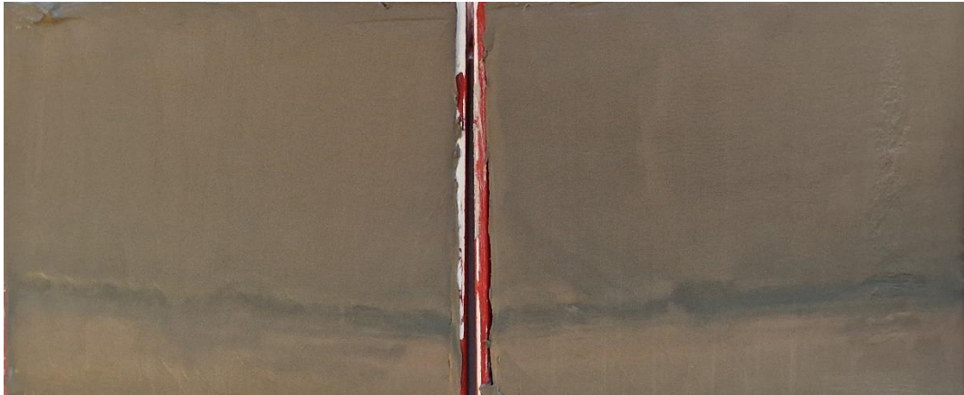
Figur 4 Borrpunkten, 23B13, 8,5 m, Jordprovet i nedre delen av mellanhylsan delad longitudinellt provhylsan med id Bjerking 818.
