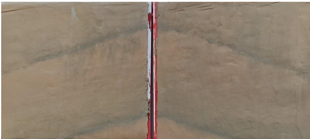
Figur 1 Borrpunkten, 23B13, 3,0 m, Jordprovet i nedre delen av mellanhylsan delad longitudinellt provhylsan med id Bjerking 1570.
