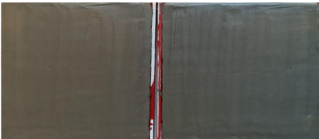
Figur 9 Borrpunkten, 23B20, 13,0 m, Jordprovet i nedre delen av mellanhylsan delad longitudinellt provhylsan med id Bjerking 1259.
