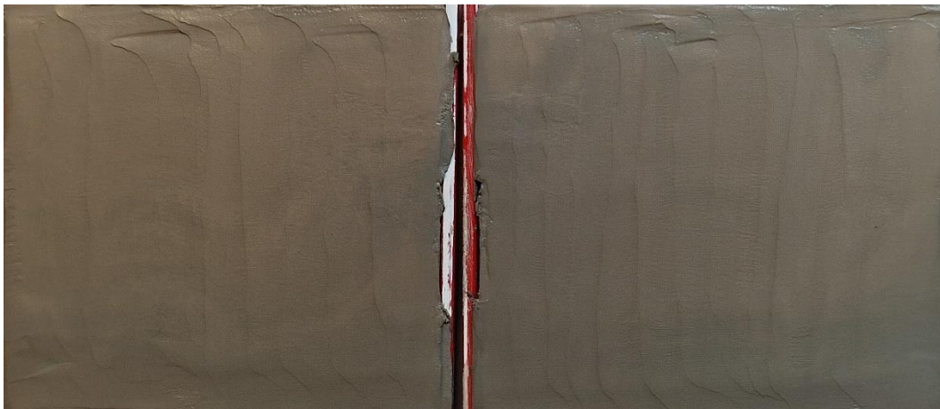
Figur 8 Borrpunkten, 23B20, 7,5 m, Jordprovet i nedre delen av mellanhylsan delad longitudinellt provhylsan med id Bjerking 1247.
