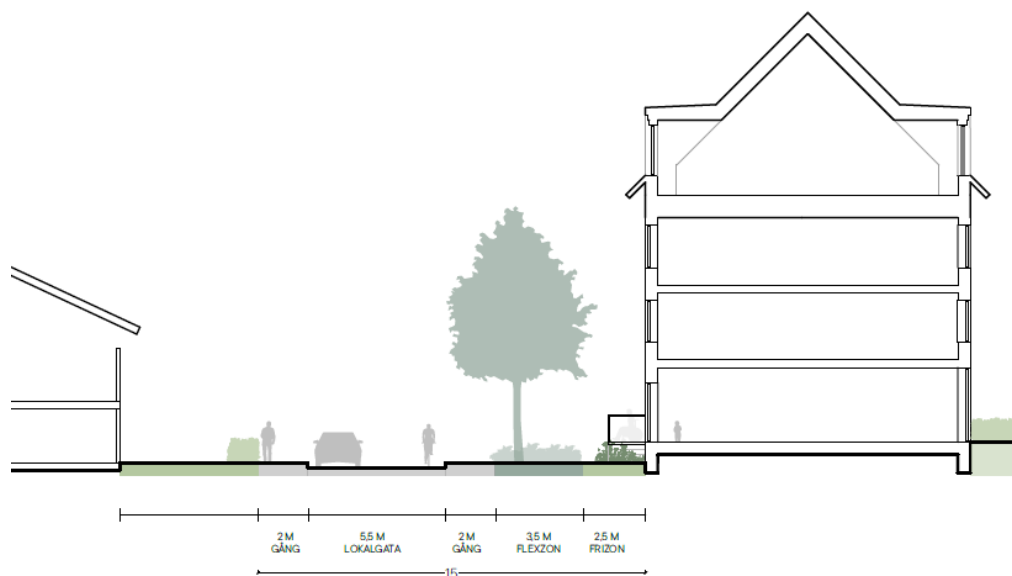
Figur 51. Illustrationen visar en gatusektion över lokalgata 1, väster om Dag H sett norrifrån (Strategisk Arkitektur, 2024).
