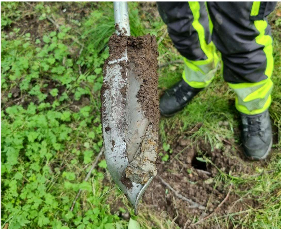
Figur 7. Jordprov S3 på 15 cm djup, visar på lera under torv.
