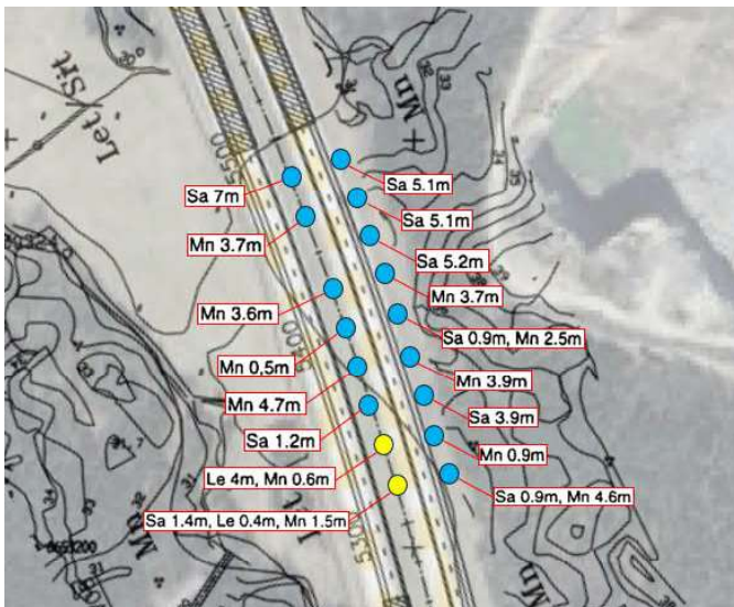
Figur 15: Sonderingsresultat, [E1], närmast täkten.
