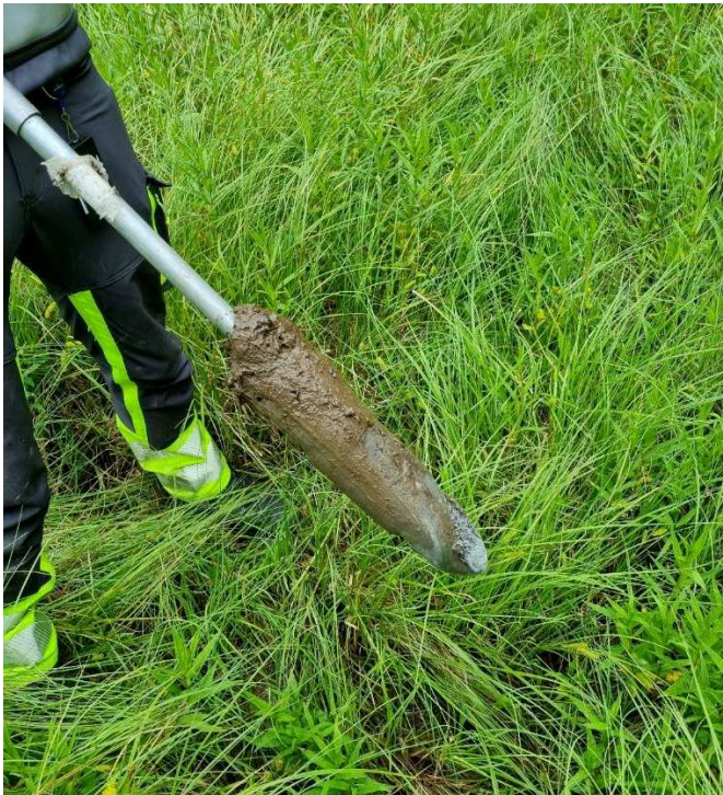
Figur 21. Jordprov G1 på 30 cm djup, visar på lera under torv.
