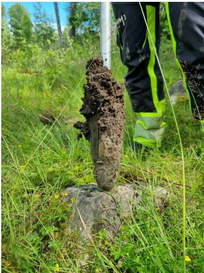
Figur 35. Jordprov G7 på 15 cm djup, visar på lera under torv.
