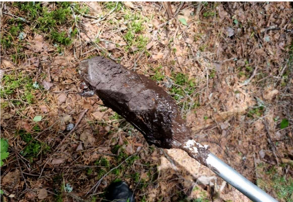
Figur 19. Jordprov S9 på 20 cm djup, visar på lera under torv.
