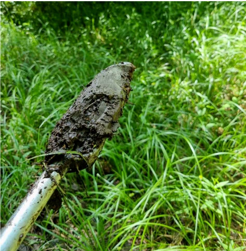
Figur 31. Jordprov G5 på 30 cm djup, visar på lera under torv.
