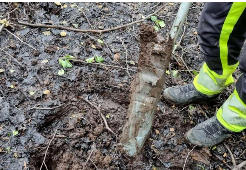
Figur 9. Jordprov S4 på 0,5 meters djup, visar på lera under torv.
