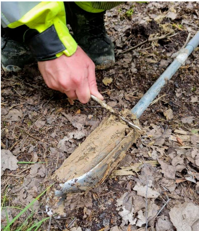
Figur 27. Jordprov G3 på 0,5 meters djup, visar på lera under torv.
