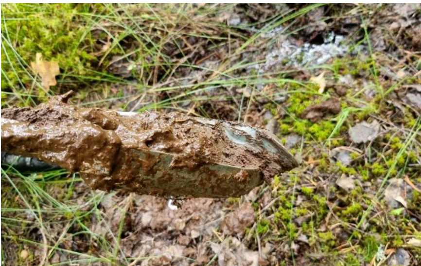
Figur 5. Jordprov S2 på ca 1,5 meter djup, visar på lera under torv.
