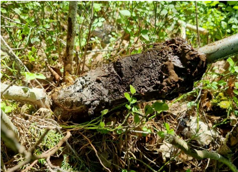
Figur 13. Jordprov S6 på 20 cm djup, visar på lera under torv.
