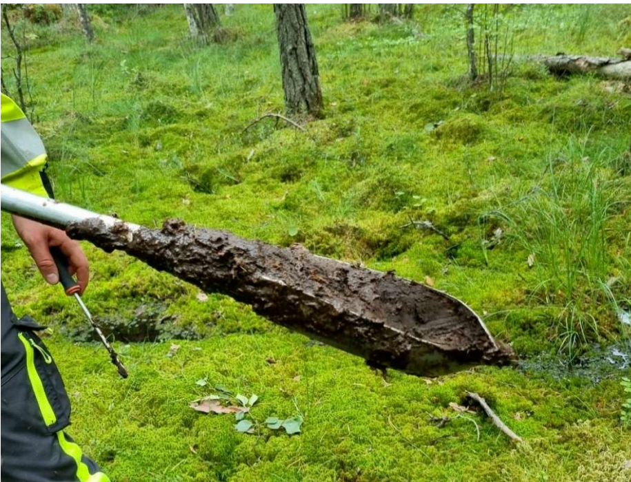
Figur 3. Jordprov S1 på ca tre meters djup visar på torv.
