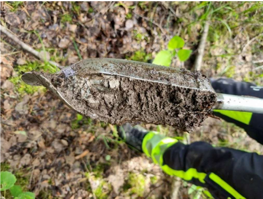
Figur 33. Jordprov G6 på 20 cm djup, visar på lera under torv.
