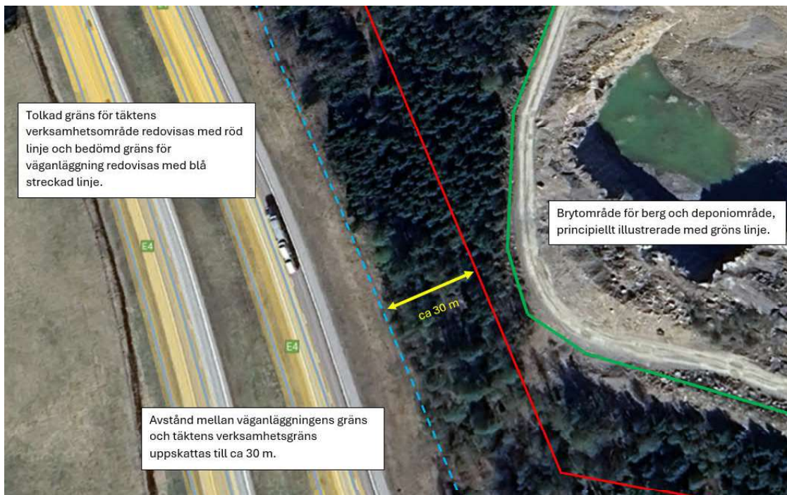
Figur 1: Principiell illustration av avstånd mellan täktens verksamhetsgräns och väganläggningens bedömda gräns (ca km 5/400).
