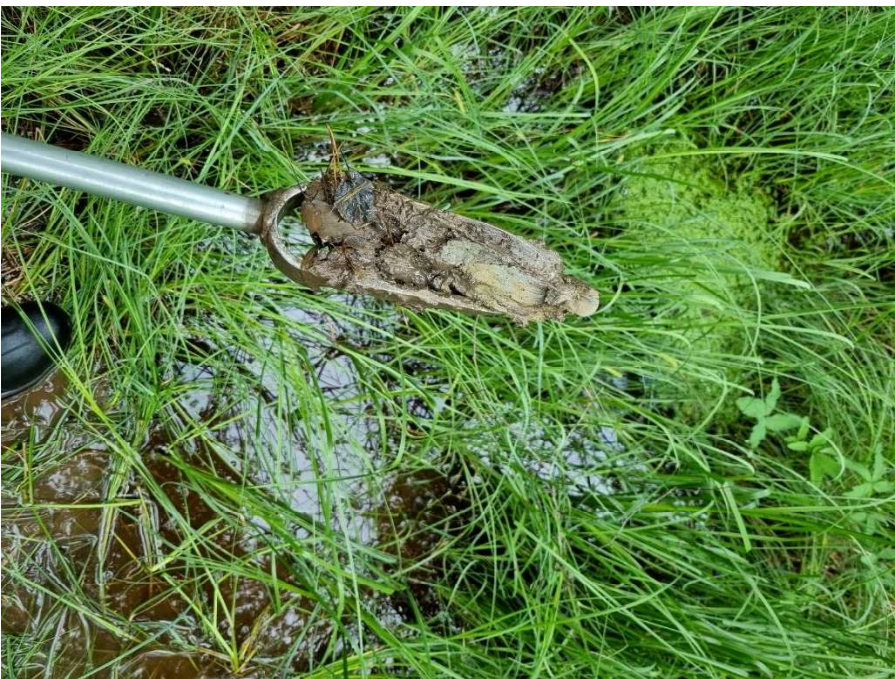
Figur 29. Jordprov G4 på 15 cm djup, visar på lera under torv.
