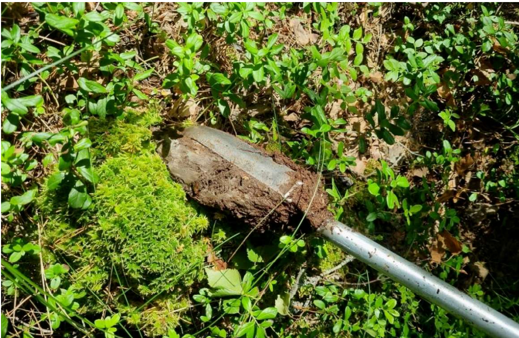
Figur 15. Jordprov S7 på 20 cm djup, visar på lera under torv.
