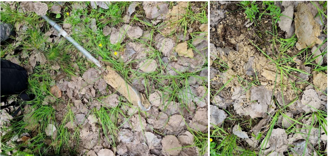
Figur 25. Jordprov G2b på 30 cm djup, visar på torr lera och lera under torv.
