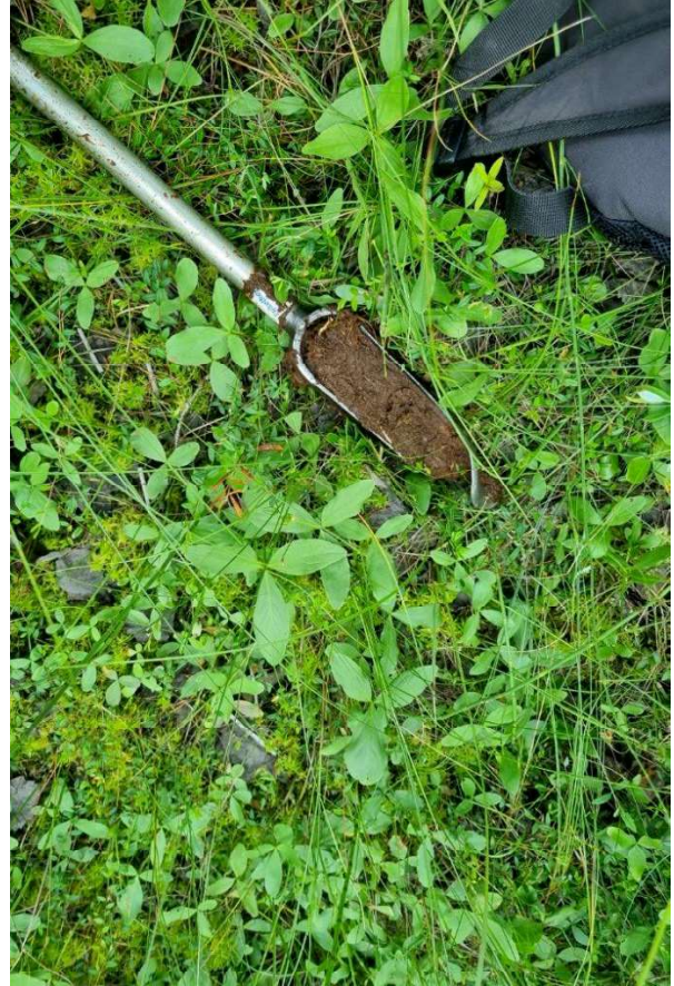
Figur 17. Jordprov S6 på tre meters djup, visar på torv.
