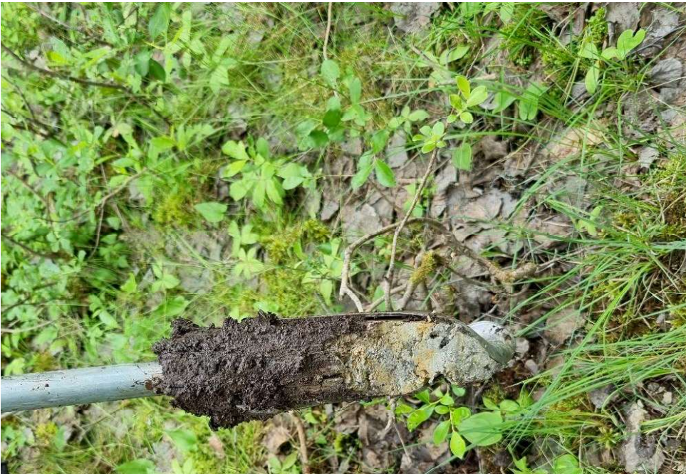
Figur 23. Jordprov G2a på 40 cm meters djup, visar på lera under hummus.
