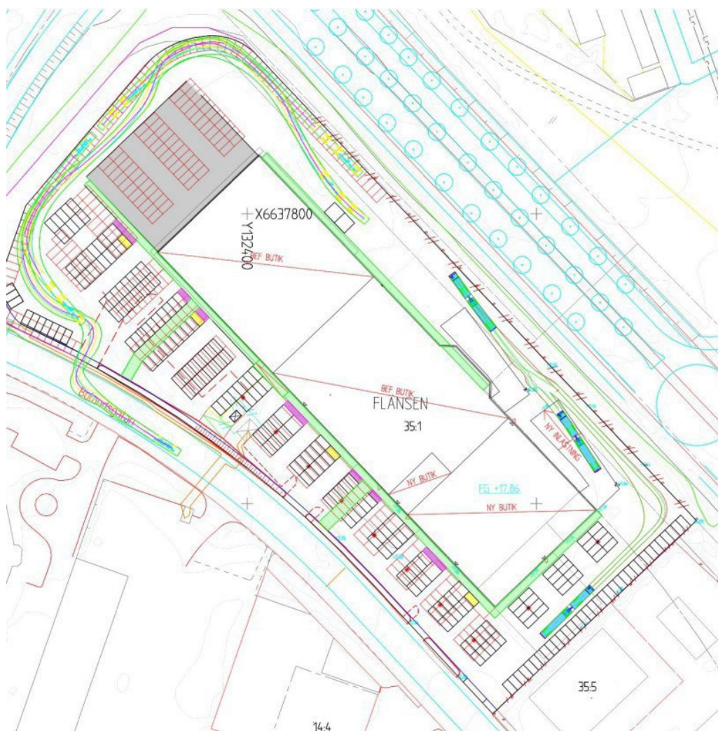
Figur 9 Situationsplan med föreslagen parkeringslösning för blandad handel. Föreslagen tillbyggnad redovisas i grått. Totalt 228 parkeringsplatser ryms inom fastigheten. Cykelparkering redovisas som rosa ytor.
