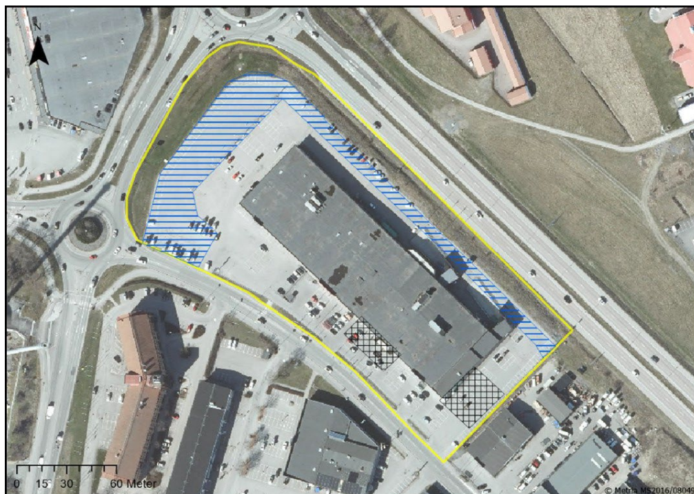
Figur 16, Nutida ortofoto med rivna delar av tidigare verksamhet markerade med svart skraffering och ny asfalt markerad med blå skraffering. Bilvårdsanläggningen/verkstaden har legat i den befintliga byggnadens sydöstra del. Bilden kommer från den historiska inventeringen avseende miljöteknik.
