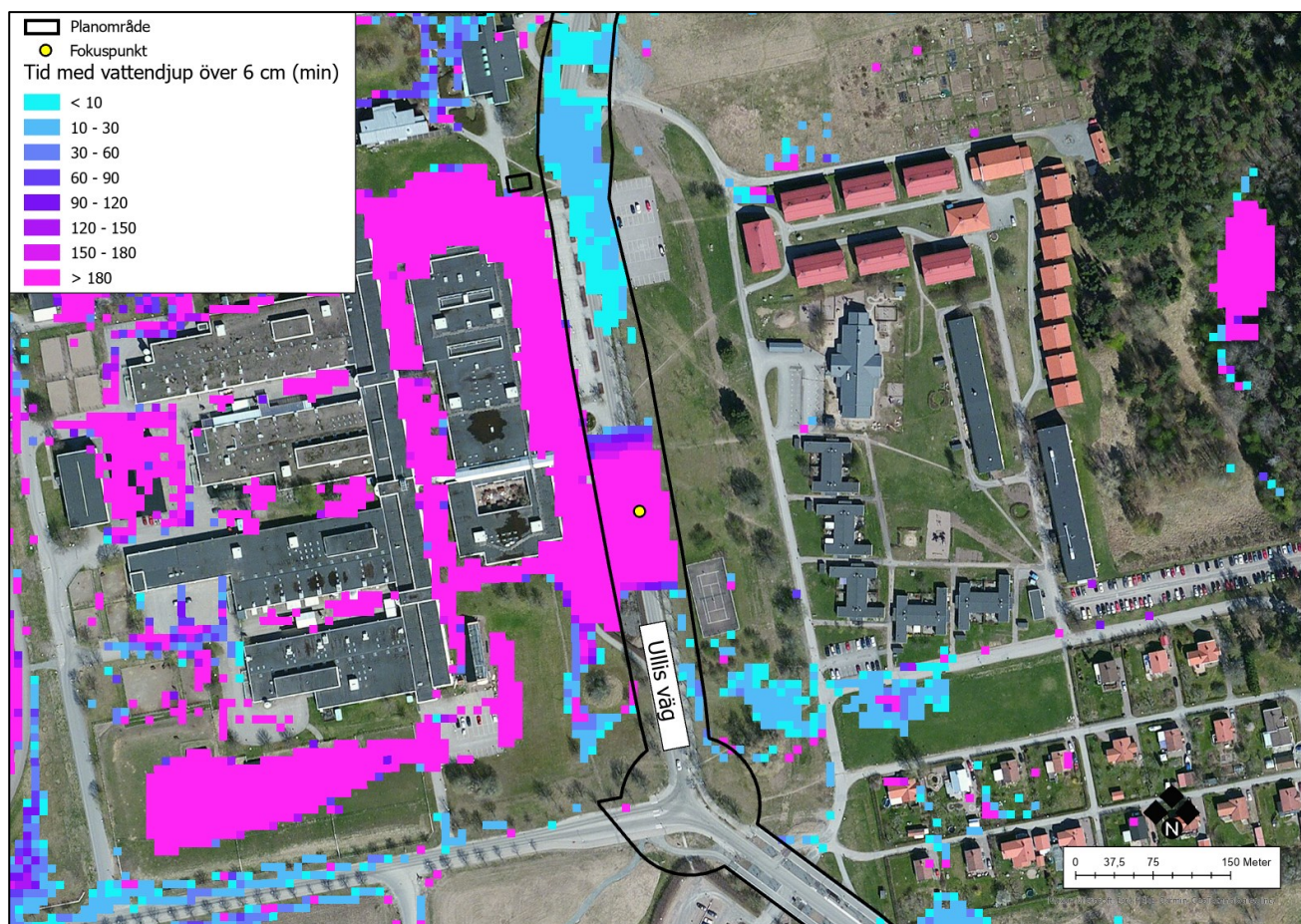
Figur 5:28. Tid då det beräknas stå vatten med ett vattendjup på minst 6 cm i Ulls väg vid studerat 100-årsregn. Planområdet är preliminärt.
