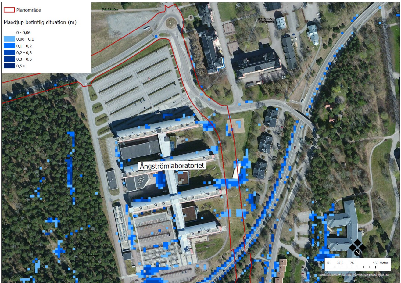
Figur 5:5. Beräknade maximala vattendjup vid befintlig situation och ett 100-årsregn inklusive klimatafaktor 1,3. Planområdet är preliminärt.
