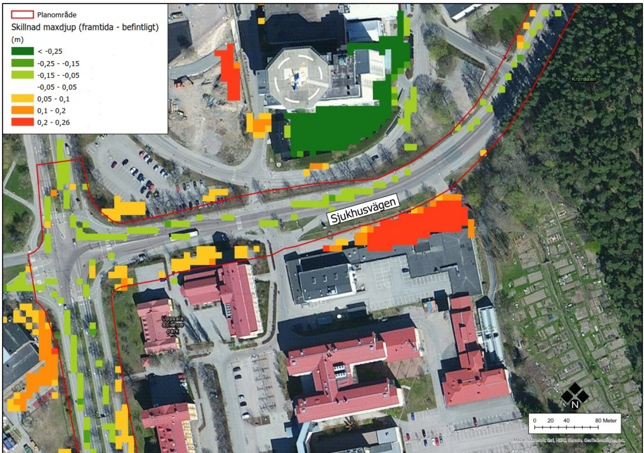
Figur 5:15. Skillnad i maximalt vattendjup mellan framtida och befintlig situation vid studerat 100-årsregn med klimatkfaktor 1.3. Planområdet är preliminärt.
