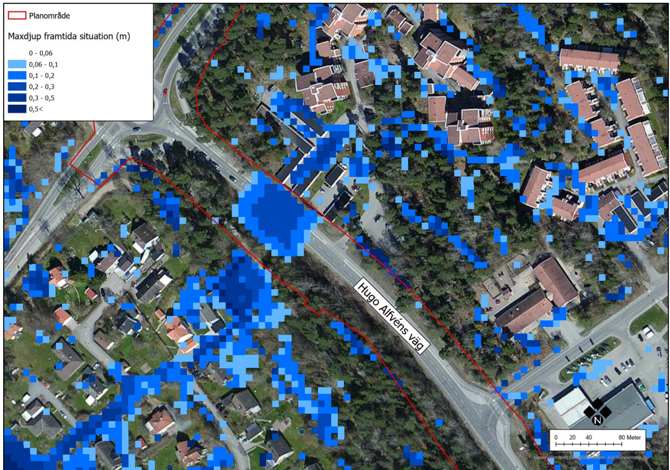
Figur 5:18. Beräknade maximala vattendjup vid planerad situation i samband med ett 100-årsregn inklusive klimatfaktor 1,3. Planområdet är preliminärt.
