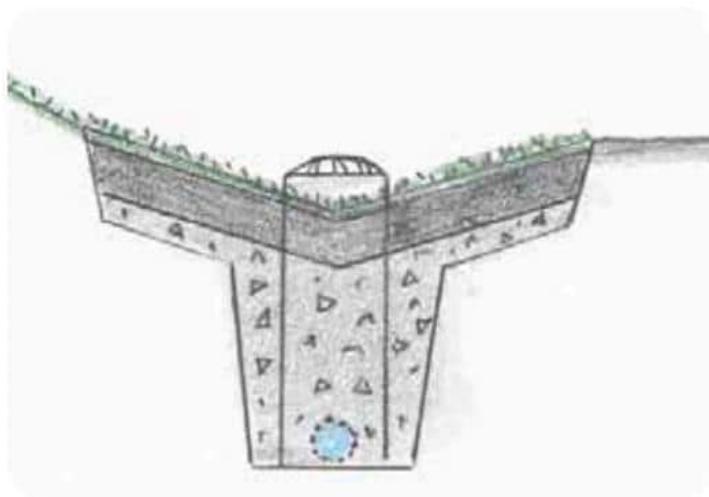
Makadamfyllt dike med dräneringsledning och kupolsil för bräddning av vatten, Sweco 2006.
