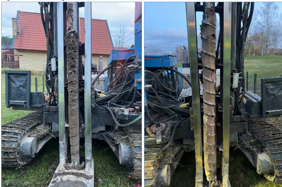
Figur 3 Fyllning i punkt 22SC06BP (0 - 1 m u my) (vänster), lera och silt i punkt 22SC04BP (1 - 2 m u my) (höger).
