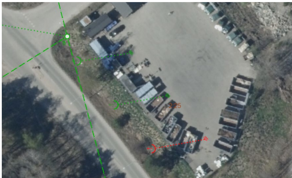
Figur 12 Föreslagen dagvattenhantering. Ledningsnät för dagvatten (grönt), i rött redovisas ungefärligt läge för en dagvattenbrunn och dess utlopp.
