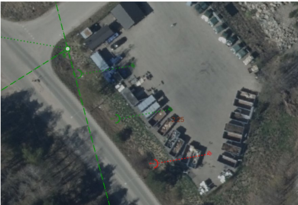
Figur 6. Ortofoto över återvinningscentralen, ledningsnät för dagvatten (grönt), i rött redovisas ungefärligt läge för en dagvattenbrunn och dess utlopp.
