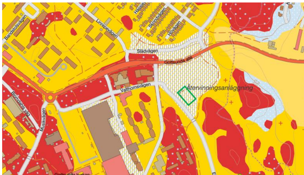
Figur 4. Jordartskarta från Sveriges geologiska undersökning, fasthetsområdet är ungefärligt markerat med grön rektangel. Beige med bruna rektanglar – fyllnadsmassor, gul färg – postglacial lera, blå med vita prickar – sandig morän, röd – berg, röd med blå prickar – berg med tunt moräntäcke.
