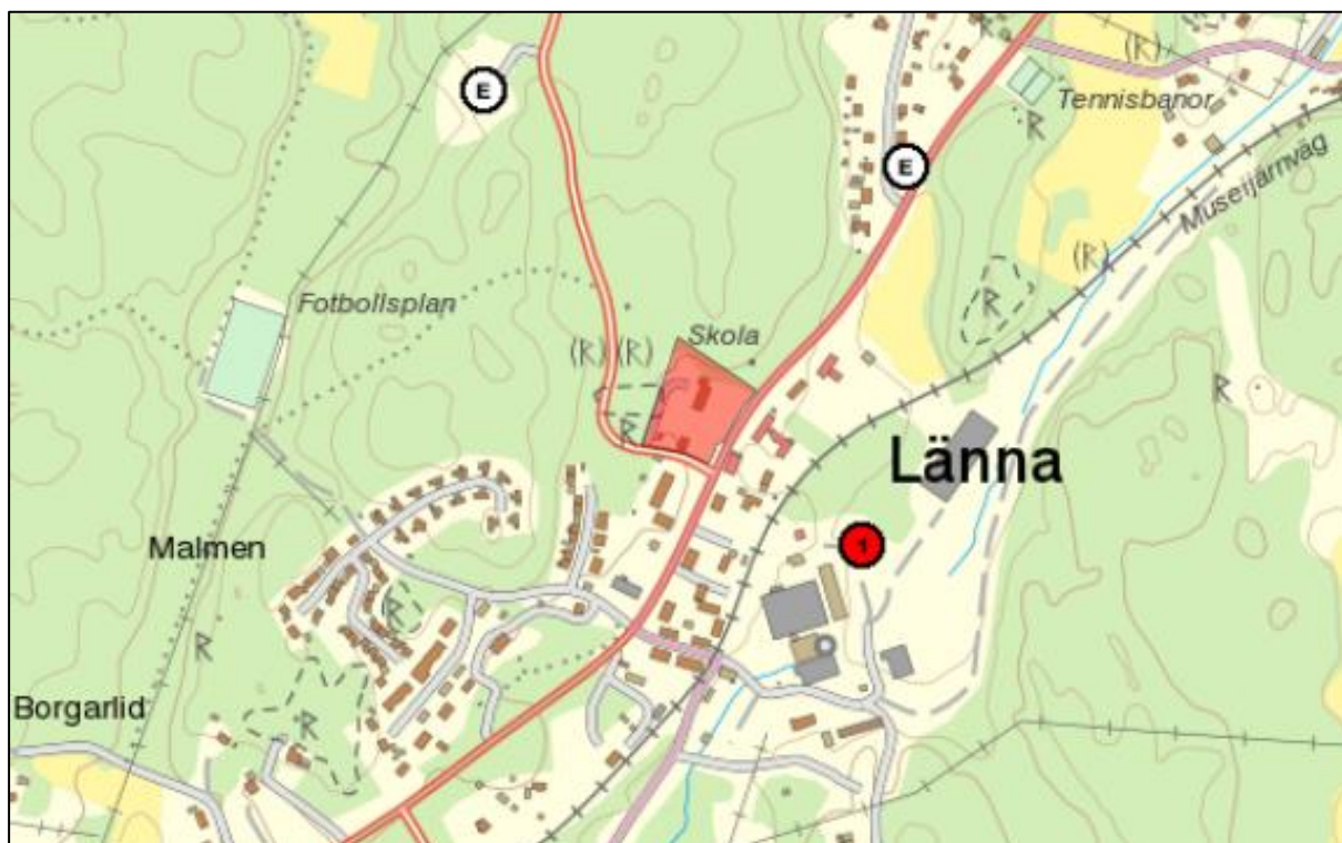
Figur 3-7. Potentiellt förorenade områden. Uppgift från Länsstyrelsernas Webb-GIS. Röd cirkel representerar klass 1 (mycket stor risk) och vit cirkel är ej riskklassat i enlighet med MIFO. Föreliggande fastighet är markerat med en ljusröd polygon.
