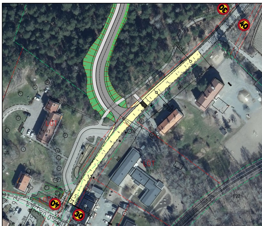
Bild 17. Alternativ 6 (utformning 1), ny anslutning mot Almungevägen och angöring över Löt 1:97 och Marma 4:66.
