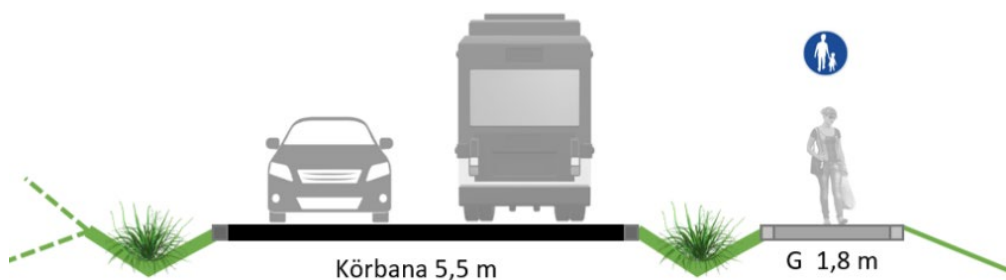
Bild 33 Sektion som visar lokalgata. Gatuområdet omfattar totalt 13 meter och innehåller en 5,5 meter bred körbana, utrymme för gångbana på 1,8 meter och övriga sidoutrymmen (diken). Tyréns.
