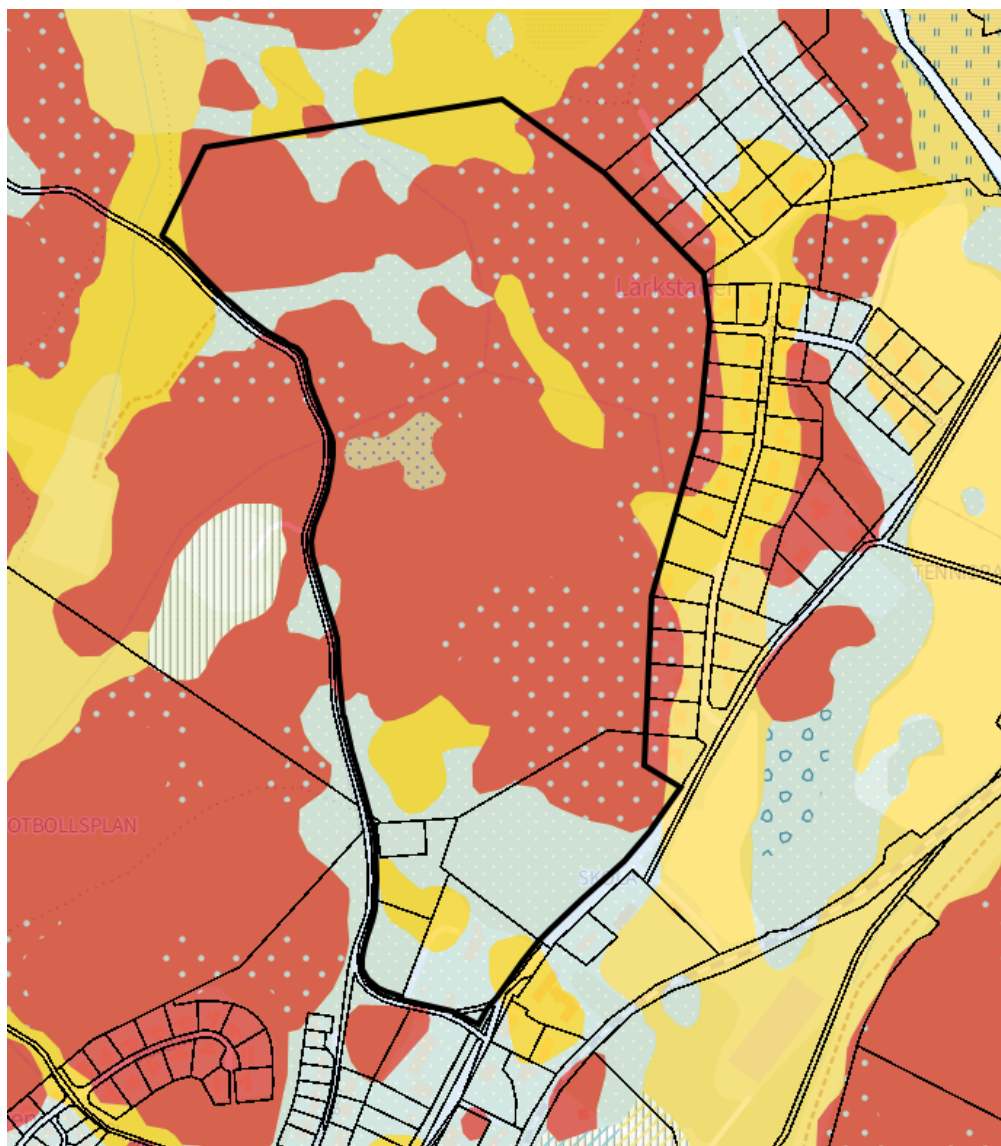
Bild 38 Jordartskarta med planområdet markerat med röd linje. Röd färg visar urberg, blå färg visar sandig och storblockig morän (ringar) samt gul färg visar lera.
