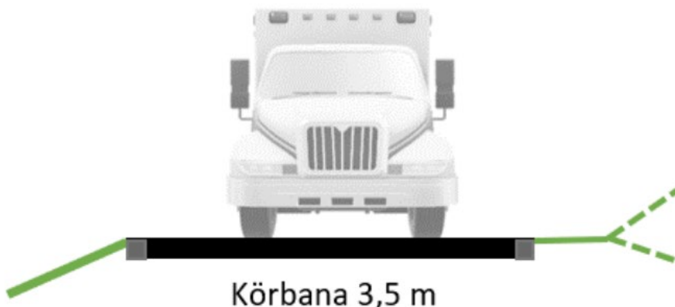
Bild 31 Sektion som visar en räddningsväg mot väg 659 i planområdets norra del. Räddningsvägen innehåller körbana på 3,5 meter och övriga sidoutrymmen. Tyréns.
