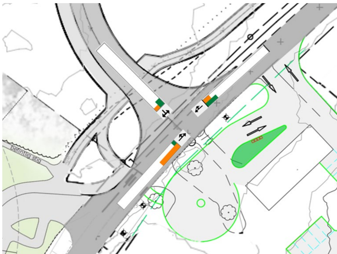
Figur 10. Belastningsgrader för korsning med Almungevägen. Grönt redovisar förmiddag och orange eftermiddag
