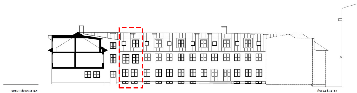
Fasaden på hus B mot gården. Den lägre delen (markerad med röd streckad linje) kan byggas upp till två våningar så att huset får samma höjd längs hela fasaden (Ritning: AQ 3 arkitektur).
