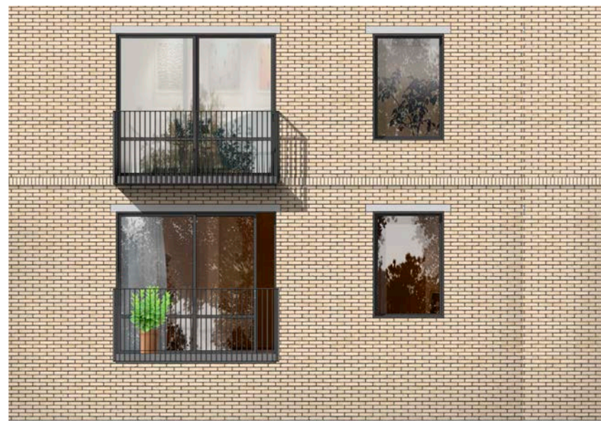
Tegel, markerad sockelväning genom två rader utskjutande tegelsten (A)
