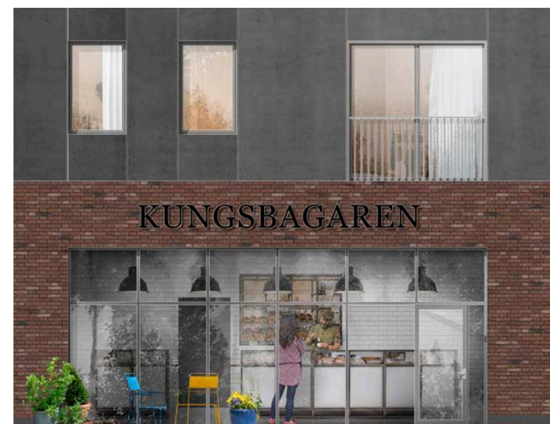
Betongfasad med sockelvåning i tegel i en mörkare nyans än fasaden (C)
