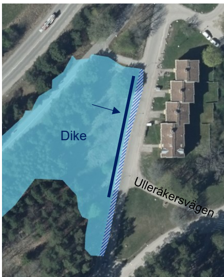
Figur 1-3. Lägerhyddsvägens bombering medför att en del av dagvattnet (skrafferad yta) rinner ner i ett dike (vars ARO redovisas i ljusblått) söder om Kungsängsleden.
