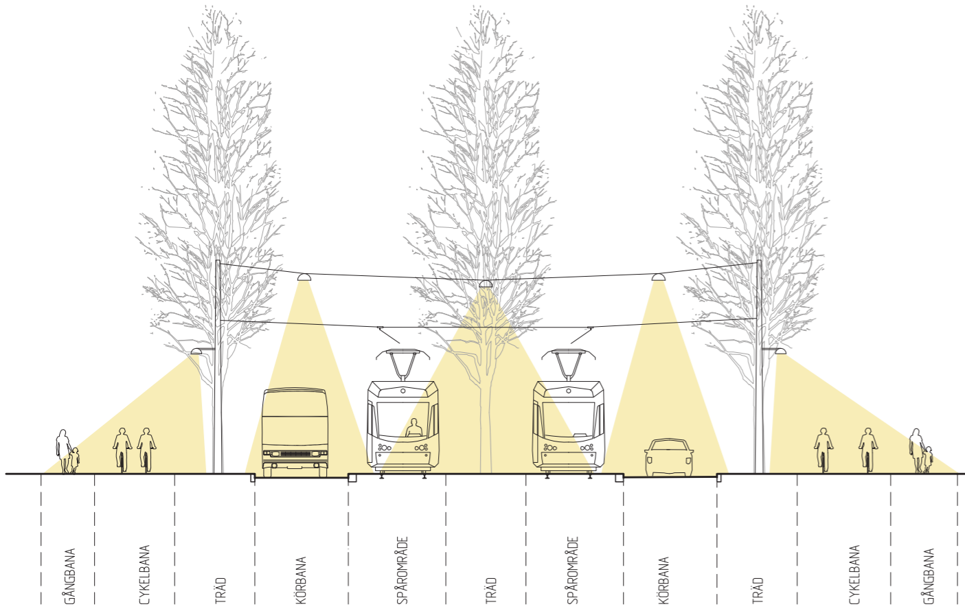
Figur 62. Kontaktledningsstolpar i linje med trädader. Exempel från Dag Hammarskjölds väg
