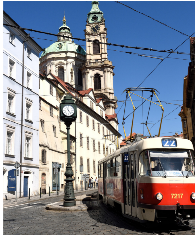
Figur 70. Fasadspänd kontaktlednings, Foto: Tim Adam, Prag
