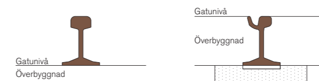
Figur 17. Principsektion för vignolräl och gaturäl.
