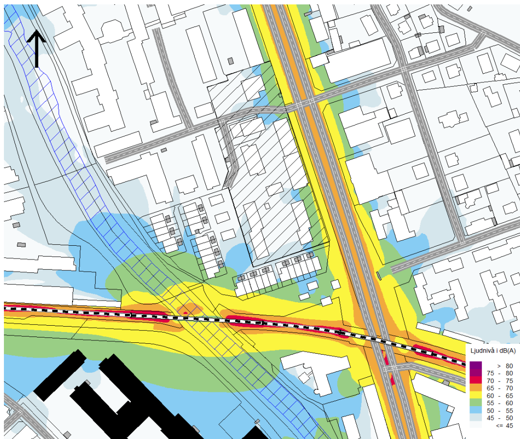
Figur 6. Ekvivalent ljudutbredning 1,5 m över mark för prognosår 2030, Kv Idun är skrafferad i bilden.
