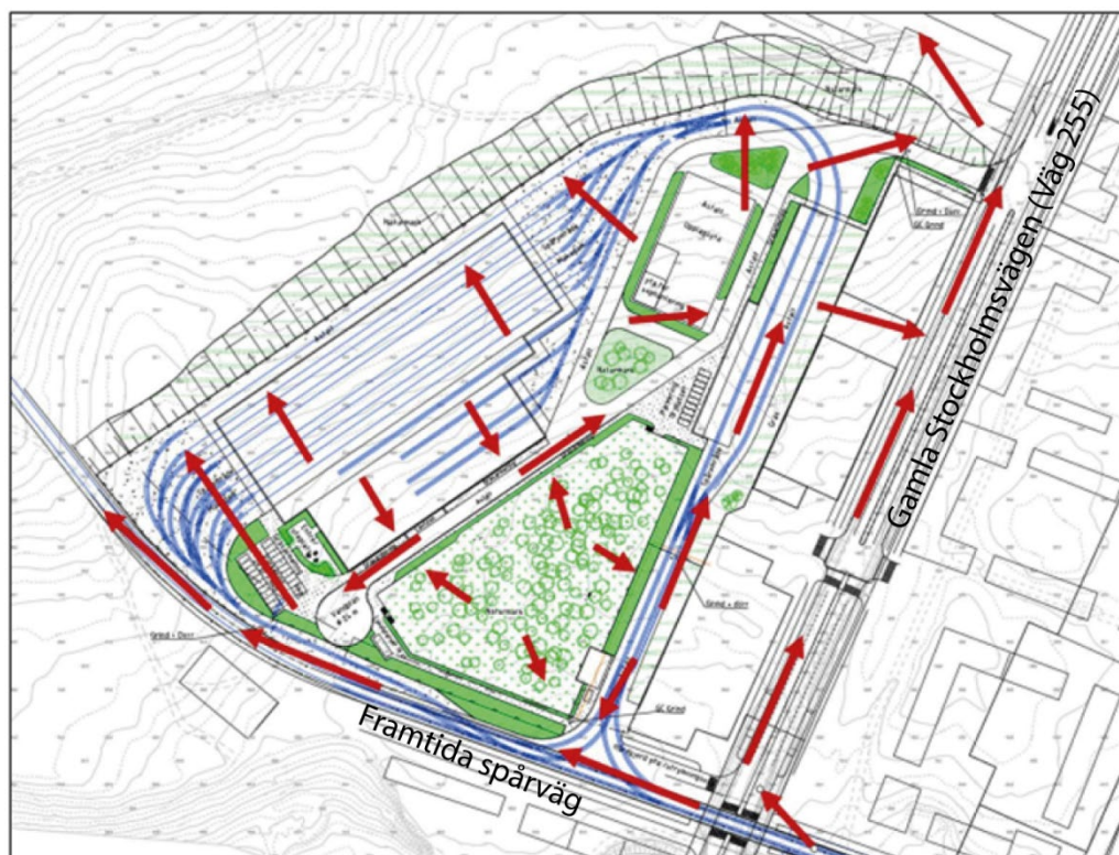
Figur 20 Skyfallshantering för planområdet. Vattnet ska obehindrat kunna rinna enligt de röda pilarna vid extrema regn.
